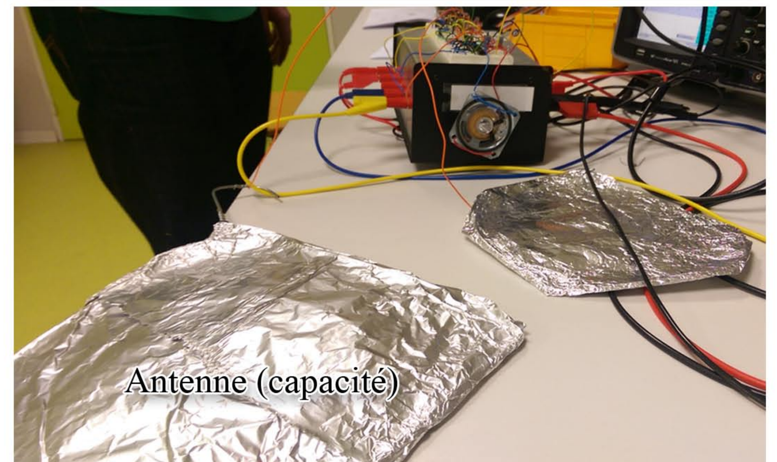
Les deux antennes fabriquées avec un cintre plié et de l'aluminium pour augmenter la surface
