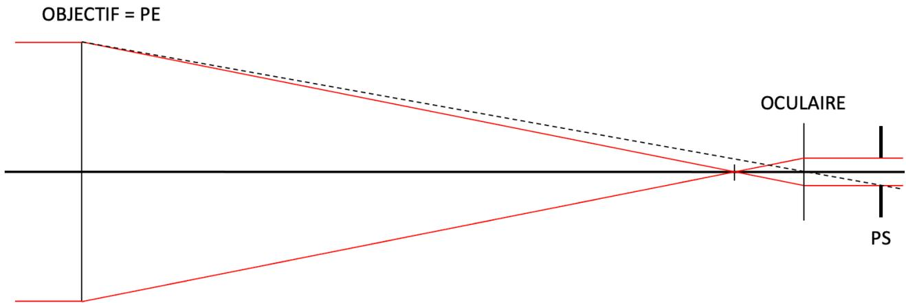
7. En utilisant le rayon qui part du bord de PE et qui va jusqu'au bord de PS, on a simplement la relation suivante (triangles semblables),
