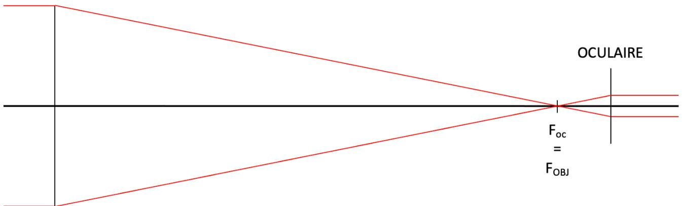
5. L'élément qui limite l'ouverture des faisceaux est ici l'objectif car il est l'élément vu sous le plus petit angle du point image en Foc dans l'espace intermédiaire. L'objectif est donc également la pupille d'entrée.
