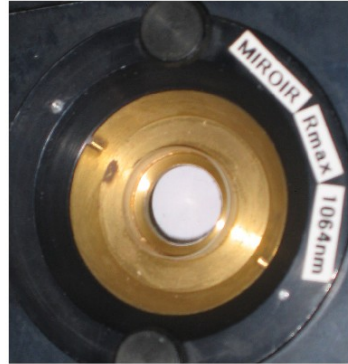
Figure E5 : Photo d'un miroir hautement réfléchissant à 1064 nm et courbe de réflectivité associée.
