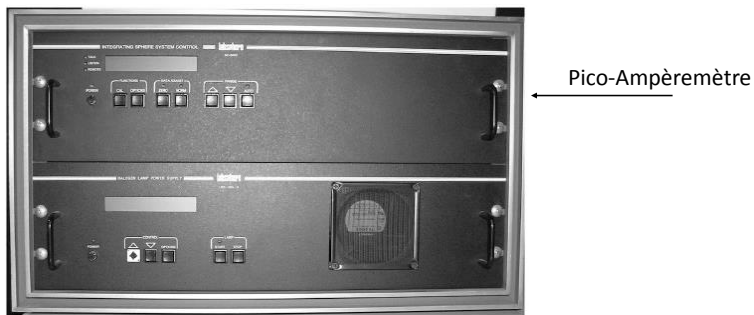
FIGURE 2.3 – Panneaux de mesure du courant
