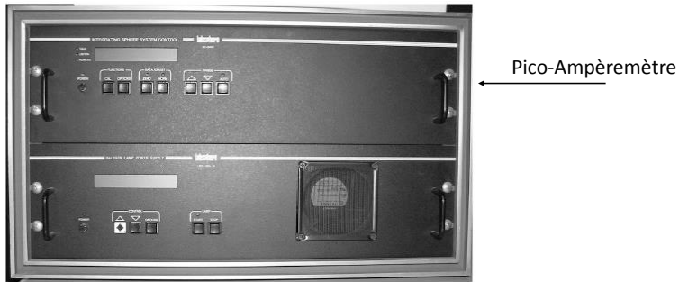
FIGURE 2.3 – Panneaux de mesure du courant
