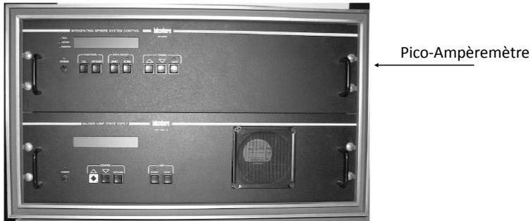
FIGURE 2.3 – Panneaux de mesure du courant
