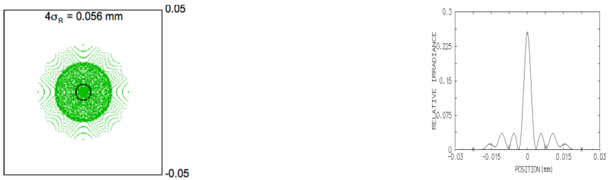
FIGURE 5 – Spot-diagramme et PSF au foyer de moindre diffusion, sur l'axe ( \lambda = 633 \text{ nm} .)
