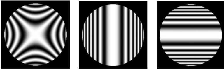
FIGURE 3.9 – Astigmatisme ( ASTIGMATISM = 3\lambda ). A gauche : Centre de courbure du miroir sphérique de référence au meilleur foyer.
