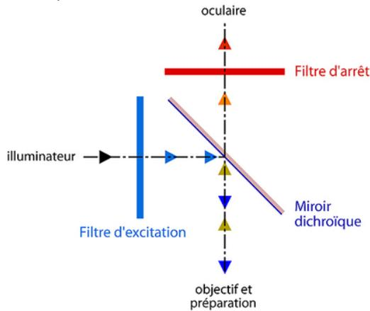
Ce "cube" remplace la lame semi-réfléchissante standard de l'éclairage Köhler par réflexion.
