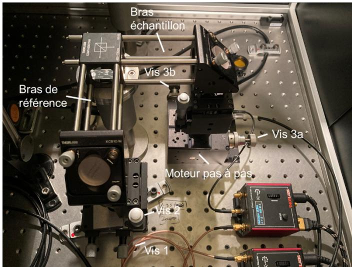
**Figure 4.** Photo du système montrant les deux bras de l'interféromètre avec les principales vis de réglage. *Vis 1* : Réglage de la différence de chemin optique (très sensible !). *Vis 2* : mise au point de l'objectif dans le bras de référence. *Vis 3a et 3b* : Déplacement xy de l'échantillon.
