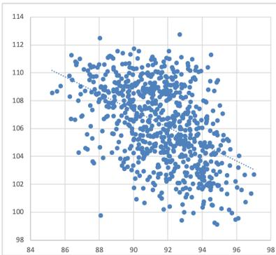
*Nuage des positions de la bille dans le piège (échelle en pixels) –
