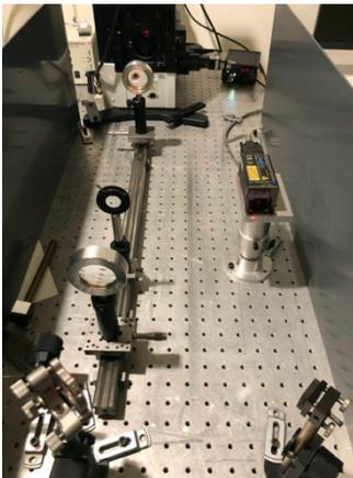
*Photo du télescope réglé afocal*
