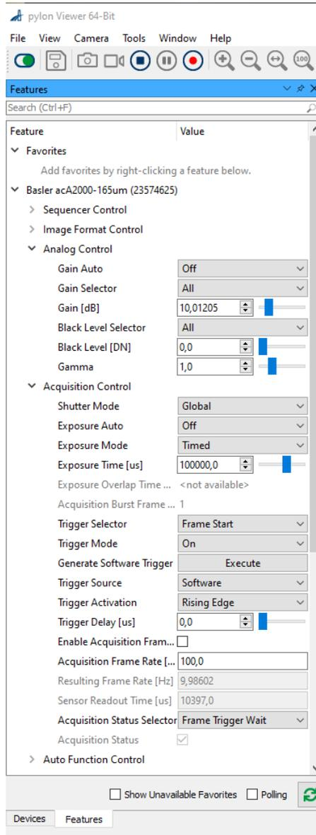
**FIGURE 2.11** – Copie d'écran montrant les réglages des paramètres d'acquisition de la caméra Basler : ici une configuration permettant de lancer une acquisition en cliquant sur `Execute`. Pour une acquisition en continu, changer `Exposure Auto` sur `Continuous` et `Trigger Mode` sur `OFF`.
