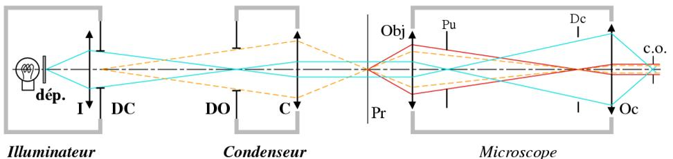
Fig2 Principe de l'éclairage Köhler (Source : Microscopie : fondamentaux d'Hervé Sauer et Joelle Surrel, site [optique-ingenieur.org](http://optique-ingenieur.org))
