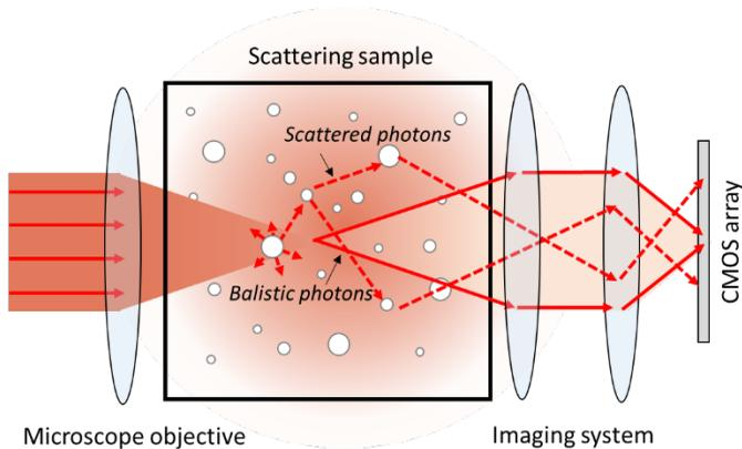
**Figure 2.** Illustration de la perte de stigmatisme engendrée par la diffusion. Les photons diffusés, très majoritaires par rapport aux photons balistiques, vont se retrouver aléatoirement dispersés dans le plan focal de la caméra, générant un fond dans l'image.
