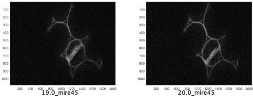
**FIGURE 2.6** – Reconstruction d'une cellule à partir de l'éclairage d'une mire de période 45 pixels du DLP. Des tensions de 19 V et 20 V ont été appliquées à la cale piézoélectrique respectivement à gauche et à droite. Le même segment tracé sur les 2 coupes correspond au bord droit de la zone de coupe sur l'image à 19 V et au bord gauche à 20V.
