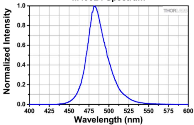
FIGURE 2.8 – Spectre d'émission de la LED Thorlabs M490L4
