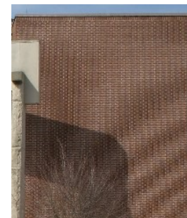
Artéfact dû à un mauvais échantillonnage des hautes fréquences (PSF < ~ pixel)
