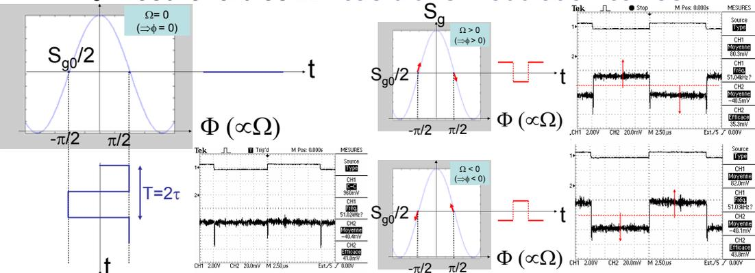
**Solution :** modulation sinusoïdale + détection synchrone (lock-in)
