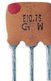
filtre passif céramique passe-bande > centré sur 10,7 MHz pour étage fi de récepteur FM
