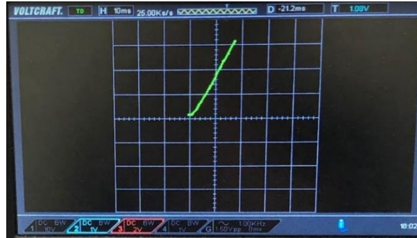
Figure 2 : Visualisation de la caractéristique statique d'une photodiode SFH206
