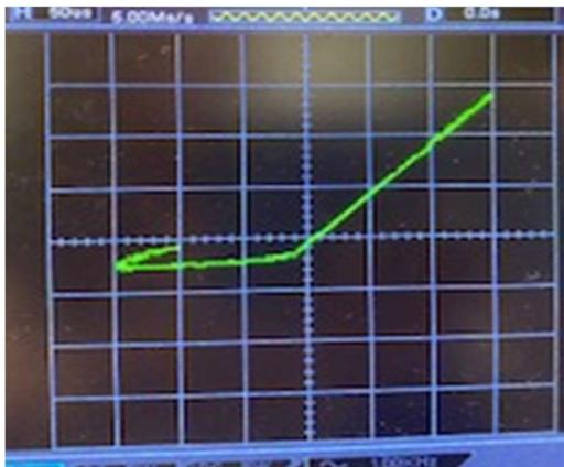
Figure 4 : Caractéristique de la photodiode
