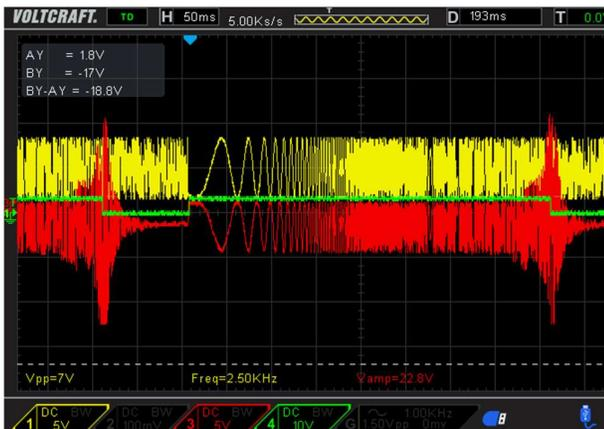
Figure 10 : Evolution de la tension aux bornes de  $R_T = 1M\Omega$  (en rouge) pour le montage « optimisé »
