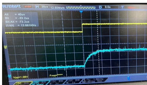
Fig. 7.a – Écran de l'oscilloscope lors de la détermination du temps de réponse du circuit
