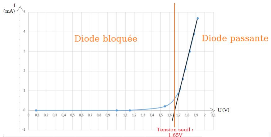
La LED possède deux modes de fonctionnement: bloqué ou passant, délimités par une tension seuil de 1,65V.
