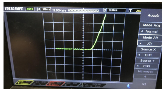
Fig.2 : Caractéristique d'une photodiode non éclairée
