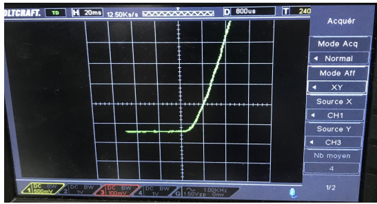
Fig.3 : Caractéristique d'une photodiode éclairée
