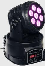
L'utilisateur pilote la lyre (couleur, intensité, orientation,...) à l'aide de la table de contrôle. Ces données sont transmises à la lyre par un câble DMX.
