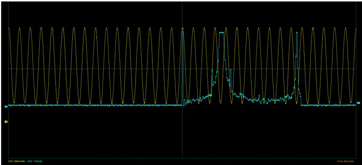
*Figure 5 : Courbe de la TF (en bleu) obtenue sur l'oscilloscope (sortie A2 de la carte Nucléo)*
