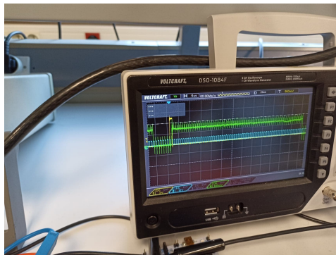
Figure 5: Signaux Clock et SI générés par le GBF et observés sur l'oscilloscope (jaune pour SI et vert pour Clock)
