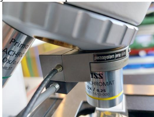
Figure 2: Cale piezo-électrique montée sur objectif de microscope
