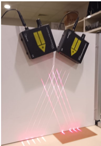
FIGURE 6 – Faisceaux des boîtiers LASER croisés
