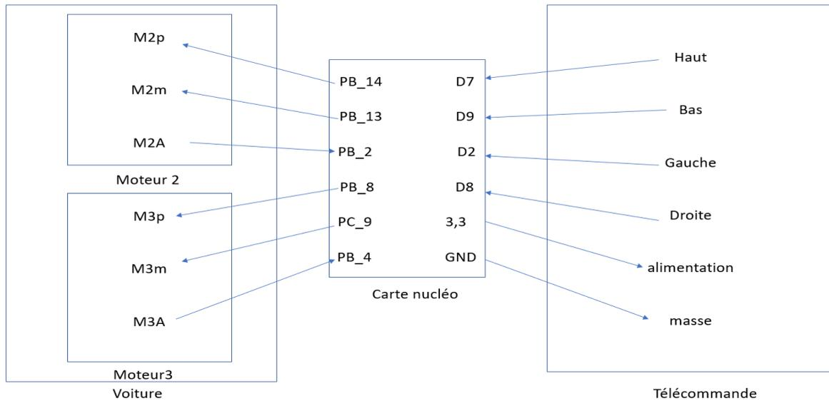
Ce schéma montre les différentes entrées et sorties qui relient la carte arduino à la télécommande et aux moteurs, les entrées numériques D... sont associées aux différentes directions, les sorties numériques PB\_14, PB\_13 ,PB\_8 et PC\_9 permettent de commander les moteurs et les entrées numériques PB\_2 et PB\_4 reçoivent des signaux en provenance des moteurs qui renseignent la carte arduino sur la vitesse des moteurs.
