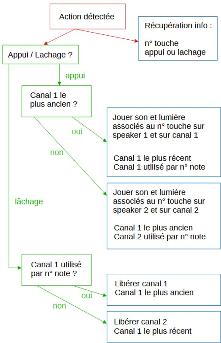
Pour mettre en pratique les conditions présentées dans le diagramme précédent, on s'appuie sur trois variables: isChannel1Old, channel2UsedBy et channel1UsedBy.
