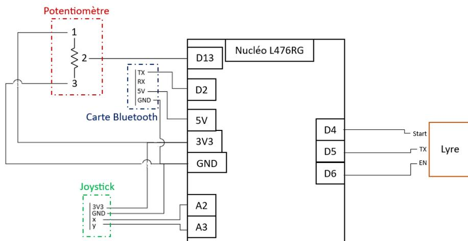
d. BPM avec Lyre (assemblage du système complet)
