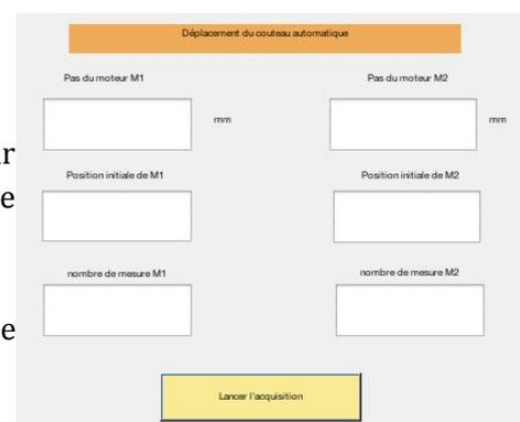
Par exemple, on choisit pour le moteur M1, qui contrôle l'axe longitudinal, une position initiale à 10 mm puis on choisit de faire 3 mesures avec un pas de 1 mm, donc le couteau aura une position finale longitudinale de 25 mm. Et pour M2 on choisit un pas de 1 mm et 10 mesures.
