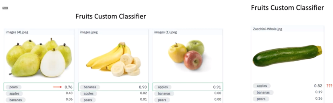
Figure 5 : à gauche, résultat efficace pour une classification de fruits avec Watson et à droite, résultat aberrant si l'on omet l'étape d'apprentissage négatif
