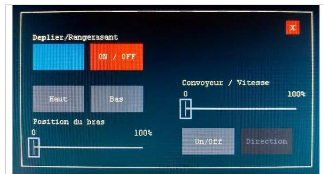
**Figure 9** : Fenêtre secondaire : menu « rasant » de l'écran tactile
