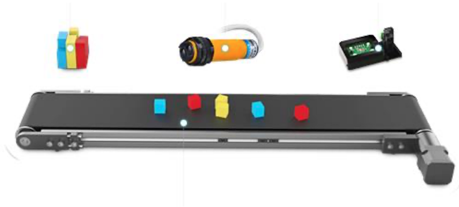
Figure 1: Schéma du prototype présentant le capteur de couleur, les cubes, et le convoyeur.
