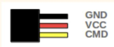
Le servomoteur à besoin d'être alimenté par un courant continu pour fonctionner. **L'alimentation continue** (souvent de 5V ou 6V) doit être branchée sur le fil rouge. **Une masse** doit être ajoutée sur le fil noir (ou marron). **La commande** du servomoteur doit être branchée sur le fil jaune (ou vert, blanc selon les cas).
