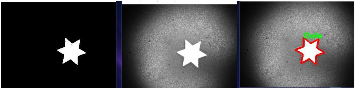
Nous avons un exemple ci-dessus : au milieu, c'est l'image captée par la caméra, à gauche, l'image issu du traitement (après le seuillage, à l'érosion et la dilatation), à droite, on dessine la forme que le logiciel détecte et son nom afin de vérifier la concordance avec la réalité.
