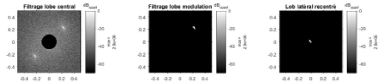
FIGURE 4 – Filtrage d'un des lobes latéraux
