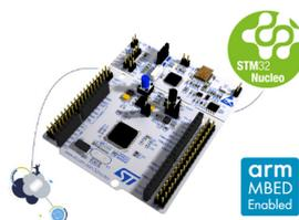
Elles sont équipées d'un débogueur ST-LINK intégré, ce qui permet de programmer et de déboguer le microcontrôleur directement sans matériel additionnel.
