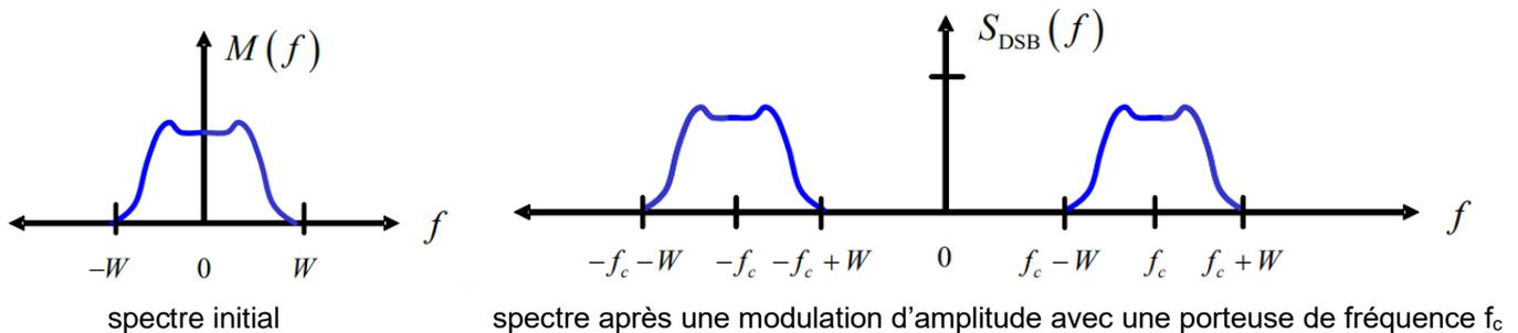
La **démodulation** d'un tel signal se fait en multipliant le signal modulé par la porteuse.
