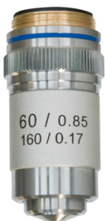
Figure : Objectif de microscope de grandissement 60 et ouvert à 0,85 – crédit : AmScope.
