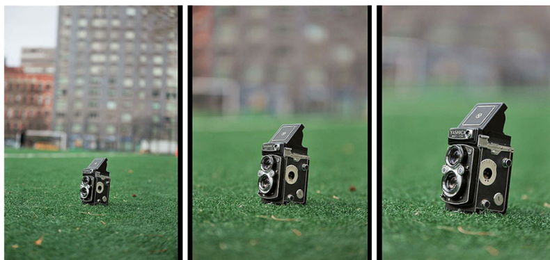
Figure : évolution de la profondeur de champ en fonction de la distance focale – crédit : non spécifié.
