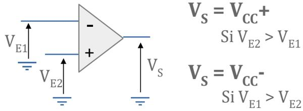
Caractéristique  $V_S = f(\epsilon)$  avec  $\epsilon = V_+ - V_-$
