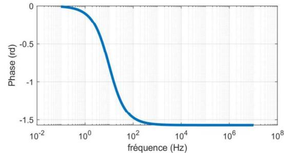
Exemple d'un ALI ayant un produit gain - bande-passante GBW = 1 MHz et une amplification différentielle de  $10^5$
