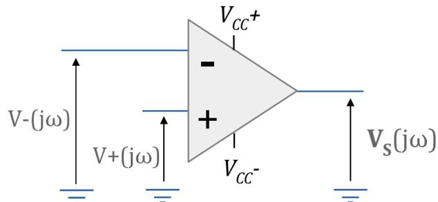
$$V_S(j\omega) = A(j\omega) \cdot [V_+(j\omega) - V_-(j\omega)]$$
