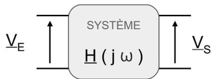
Un système peut être caractérisé par sa réponse en fréquence, qu'on appelle aussi fonction de transfert  $H(j\omega)$
