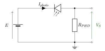
Une photodiode est un composant électronique fournissant un courant d'intensité proportionnelle à la valeur de l'éclairement appliquée sur celle-ci. Les caractéristiques de la photodiode étudiée (SFH206K) sont fournies ci-dessous :
