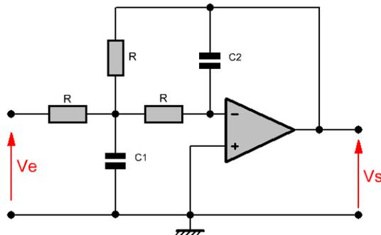
La pulsation caractéristique de ce filtre vaut  $\omega_c = \frac{1}{R\sqrt{C_1C_2}}$  et le facteur de qualité vaut  $Q = \frac{1}{3} \cdot \sqrt{\frac{C_1}{C_2}}$ .
