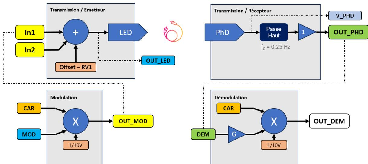
L'entrée **MOD** correspond à la modulante, soit  $V_m(t)$  (fréquence lente), et l'entrée **CAR** correspond à la porteuse, soit  $V_p(t)$  (fréquence rapide).
