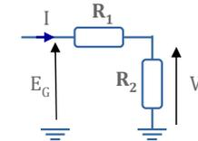
$V_S = R_2 \cdot I$  et  $E_G = (R_1 + R_2) \cdot I$
