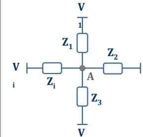
En un nœud A d'un réseau de branches en parallèle de générateurs de tension réels (source de tension et impédance)
