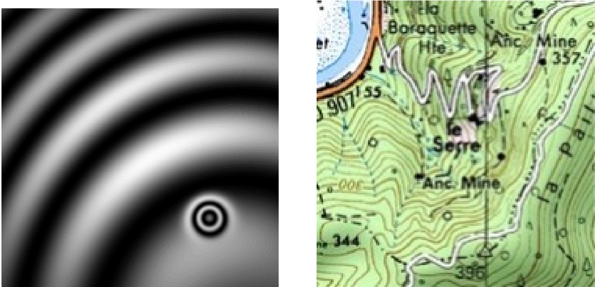
FIGURE 2 – Interférogramme et lignes de niveau
