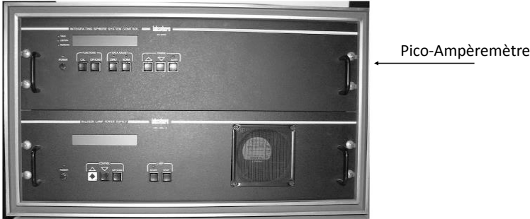
FIGURE 2.3 – Panneaux de mesure du courant
