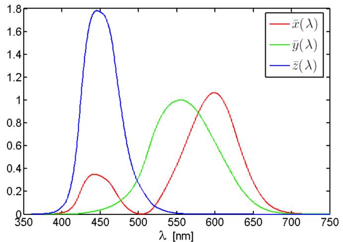
**FIGURE 4.1** – Définition des tristimuli XYZ à partir de la luminance énergétique spectrique  $L_{\lambda}(\lambda) = \frac{\partial L}{\partial \lambda}(\lambda)$  d'une source physique ( $L_{\lambda}(\lambda) \geq 0$ ). Crédit :
