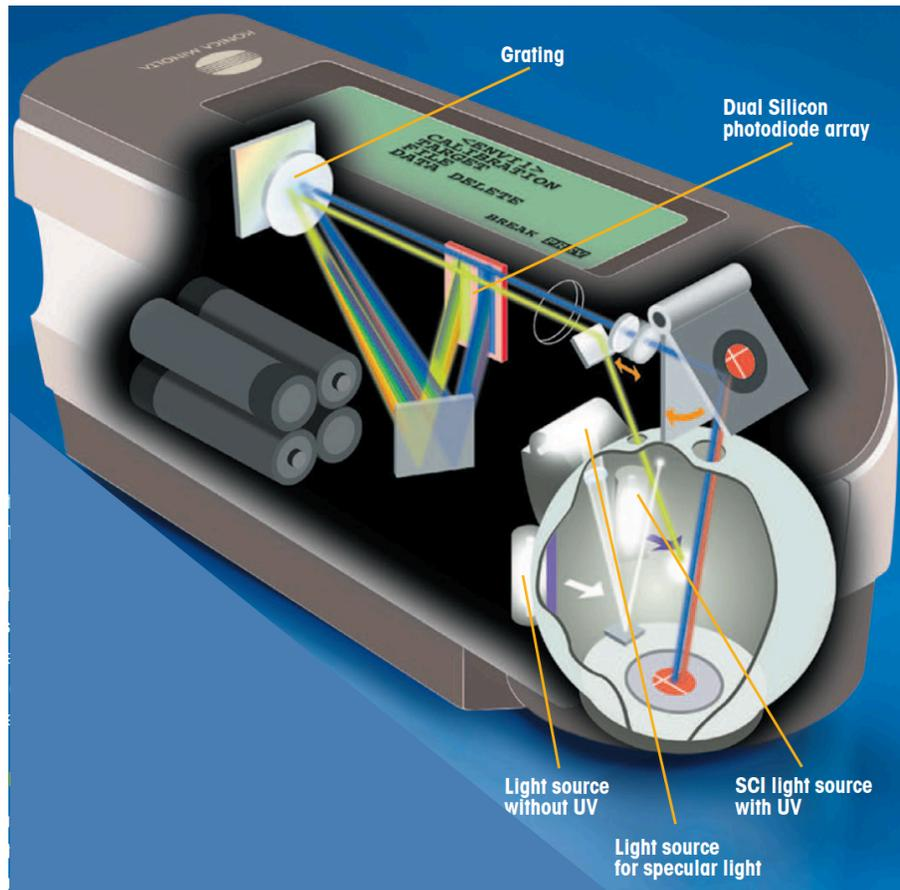
FIGURE 4.9 – Schéma de principe du fonctionnement du spectro-colorimètre.
