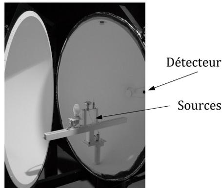
FIGURE 2.1 – La sphère intégrante LabSphere utilisée en TP.
