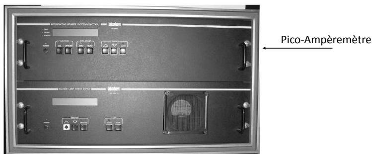
FIGURE 2.3 – Panneaux de mesure du courant
