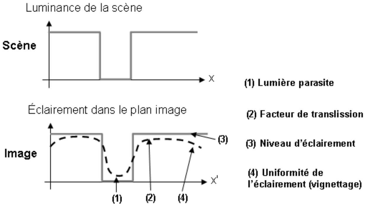
FIGURE 3.1 – Caractéristiques photométriques des systèmes optiques
