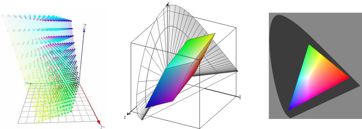
**FIGURE 4.7** – Représentations du solide des couleurs synthétisables (*gamut*) dans le cube des couleurs (deux figures de gauche). Le maillage (à gauche) est lié à la discrétisation des commandes de la synthèse. Une figure 3D orientable est aussi disponible (en tapant »SolideXYZ\_synth\_sRGB ), pour vous aider à visualiser ce volume. Triangle des couleurs synthétisables dans le plan  $(x, y)$  (à droite). Crédits : Mathieu Hébert, cours "Colorimetry" 2AS, Hervé Sauer cours de colorimétrie 2AP.
