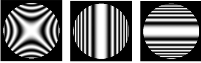
FIGURE 3.9 – Astigmatisme ( \text{ASTIGMATISM} = 3\lambda ). A gauche : Centre de courbure du miroir sphérique de référence au meilleur foyer.
