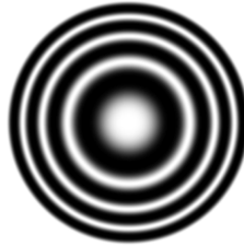
FIGURE 3.6 – Défaut de mise au point par rapport au foyer paraxial (FOCUS = 2\lambda )
