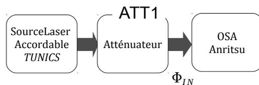
↪ Mesurer le spectre de ce signal laser. Vérifier que la valeur de la puissance est voisine de celle mesurée au puissance-mètre. L'écart observé peut être imputé à l'usure... du connecteur d'usure (!) à l'entrée de l'OSA. Régler la longueur d'onde du laser accordable à 1550 nm.
