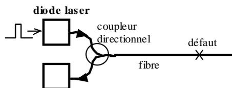
FIGURE 3.3 – Principe de la mesure par réflectométrie.
