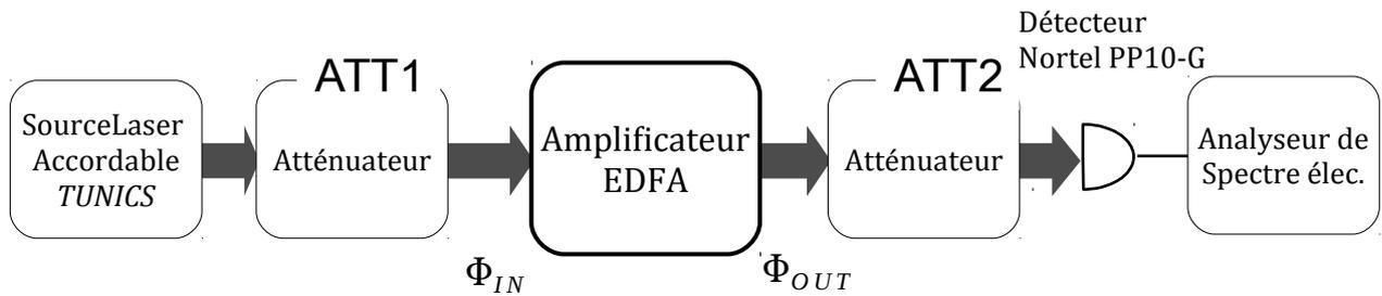
↪ Pour une puissance de pompe maximale (c'est à dire. P<sub>1</sub> et P<sub>2</sub> ON), mesurer la densité spectrale de puissance de bruit (en W/Hz) à 100 MHz à la sortie de l'amplificateur pour une atténuation nulle.
