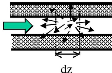
FIGURE 3.6 – Rétrodiffusion d'une portion  $dz$  de la fibre.
