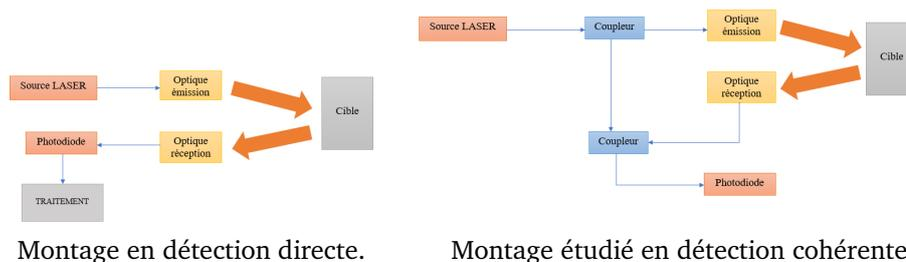
FIGURE 5.1 – Schémas de principe des deux modes de détection possibles d'un LIDAR
