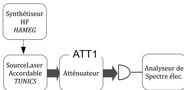
↪ Pour des atténuations de  $ATT1 = 0, 1, 2, 3, 5$  dB, mesurer la puissance du signal à 100 MHz (en dBm) à l'aide de l'analyseur de spectre électrique. Pour cela, sortir du mode de mesure de bruit et utiliser la fonction `peak find` de l'appareil.
