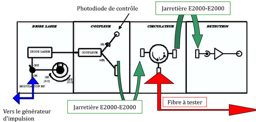
FIGURE 3.8 – Face avant de l'OTDR SupOptique
