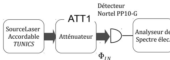
↪ Mesurer la densité spectrale de puissance du bruit pour un flux nul envoyé sur le détecteur (en W/Hz et en  $\text{dBm}_{@1 \text{ Hz}}$ ) à 100 MHz (bruit propre de l'analyseur et bruit d'obscurité du détecteur).
