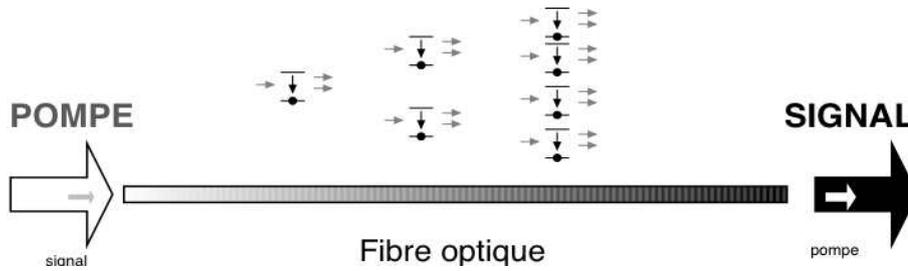
FIGURE 4.1 – Schéma de principe de l'amplification optique.
