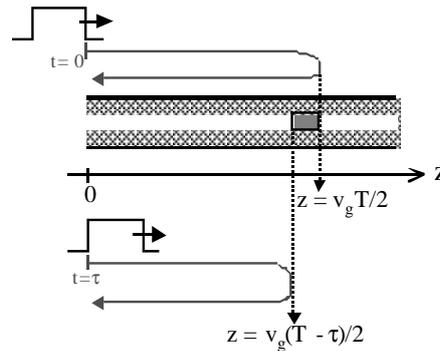
FIGURE 3.7 – Impulsion rétrodiffusée.
