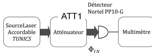
↪ Mesurer la tension de sortie continue du photodétecteur en l'absence de signal Laser (ATT1 sur la position  $\infty$ ) à l'aide du multimètre de précision (on notera la présence d'un bouchon  $50 \Omega$ ).
