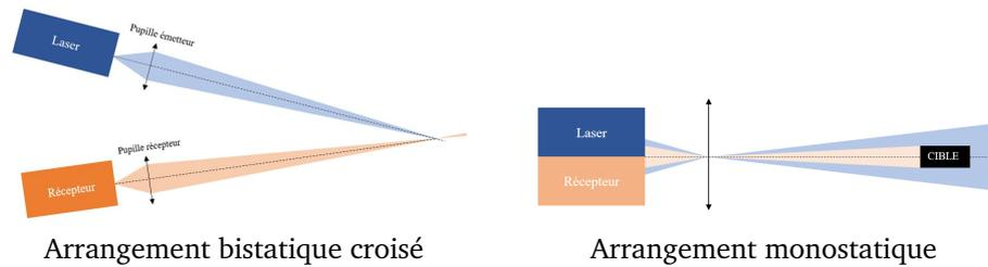
FIGURE 5.2 – Principe des deux géométries possibles
