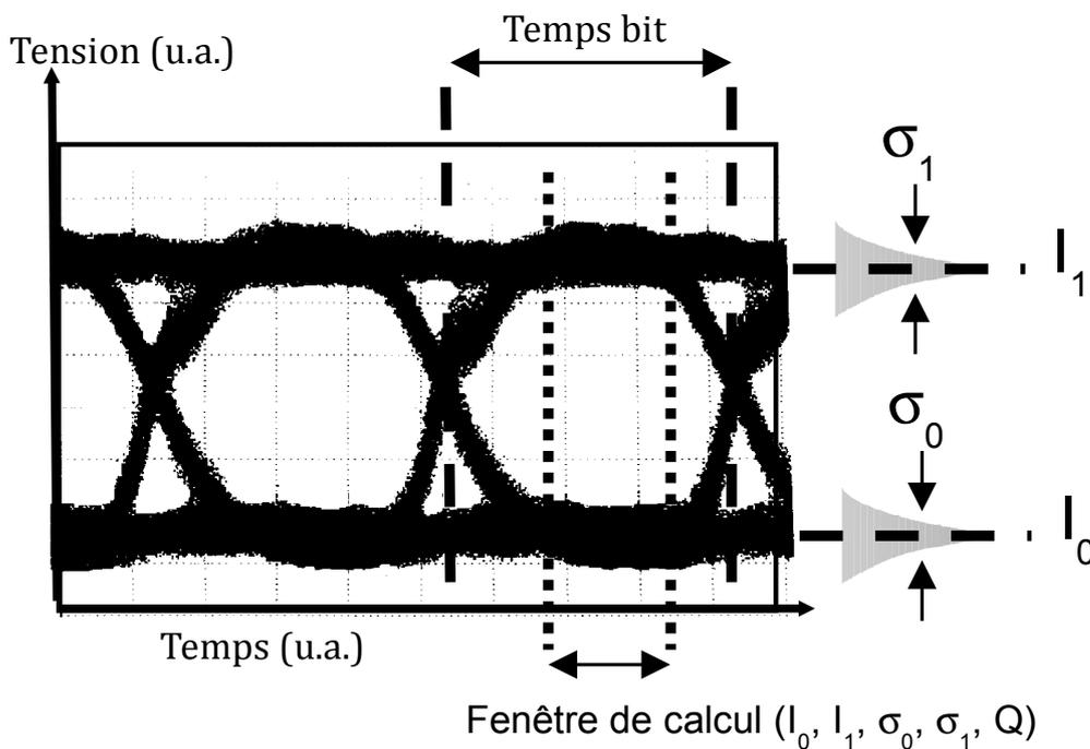
FIGURE 1.3 – Exemple de diagramme de l'oeil
