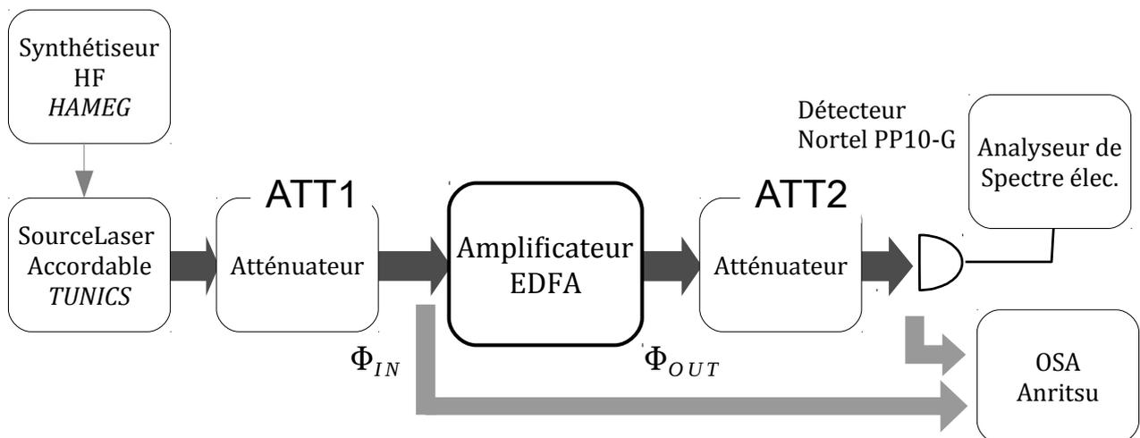
FIGURE 4.5 – Dispositif de mesure
