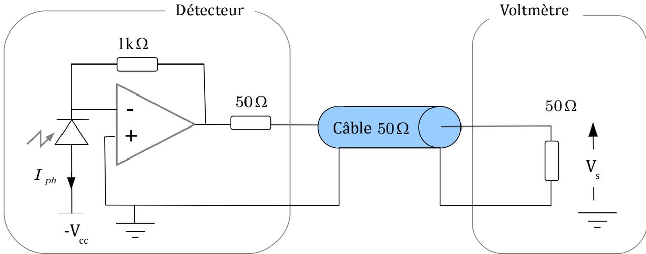
FIGURE 4.3 – Circuit de détection. Mesure de la composante continue du signal.
