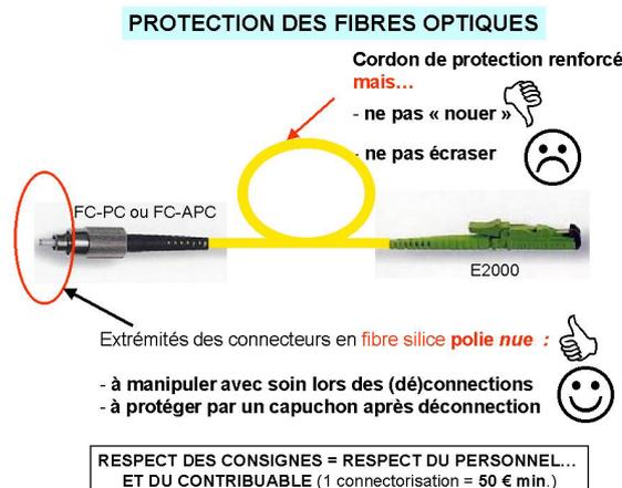
Ne pas mélanger les connecteurs : ne jamais connecter une fibre PC (manchon noir) à une fibre APC (manchon vert) ! Ne pas laisser traîner les fibres sur la table. Ranger les soigneusement au cours du TP et après utilisation.
