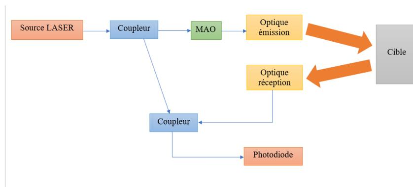
FIGURE 5.7 – Schéma de principe du montage avec le modulateur acousto-Optique
