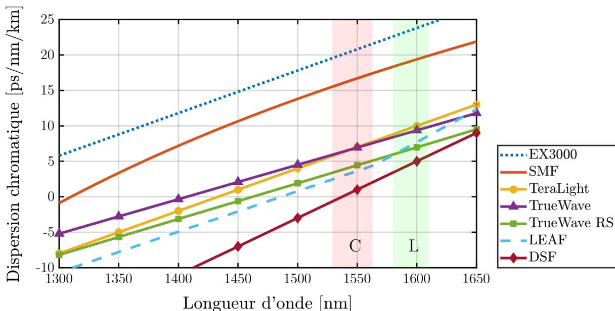
FIGURE 1.2 – Dispersion chromatique de plusieurs types de fibres
