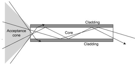
FIGURE 3.2 – Ouverture Numérique d'une fibre optique.
