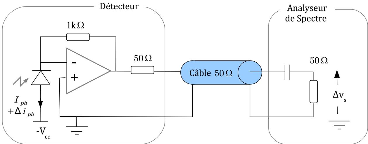
FIGURE 4.4 – Circuit de détection. Mesure de la composante de bruit du signal.
