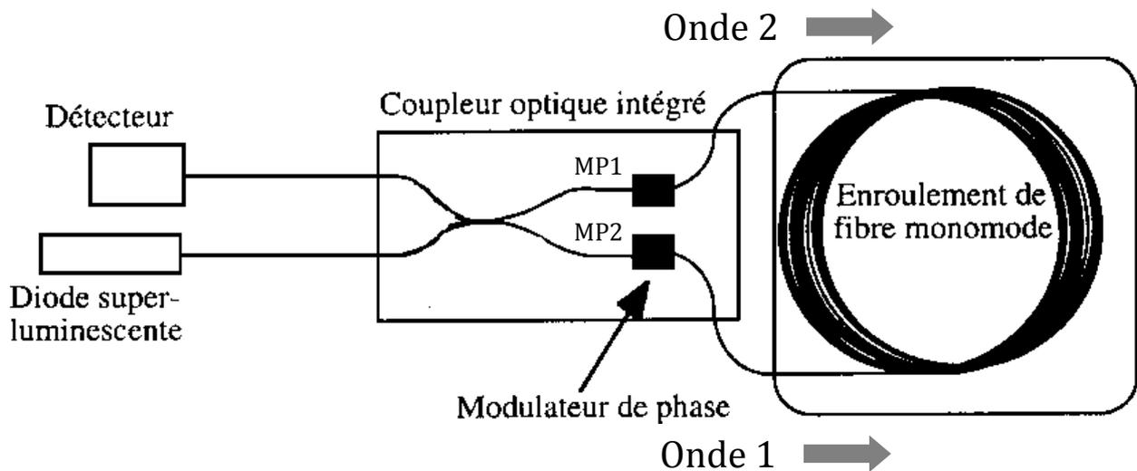
FIGURE 2.5 – Interféromètre avec un composant coupleur et modulateurs intégrés.
