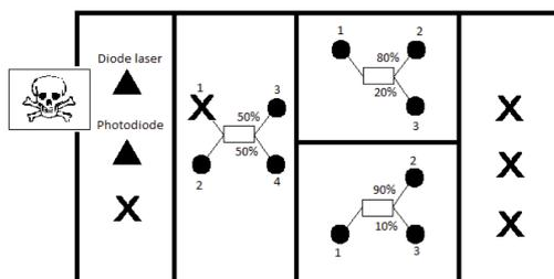
FIGURE 5.4 – Schéma simplifié du bloc fibré. NE SURTOUT PAS TOUCHER AUX FIBRES FIXÉES A LA DIODE LASER ET A LA PHOTODIODE.
