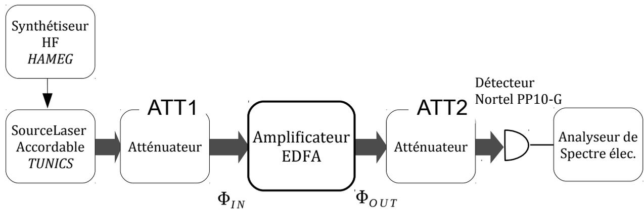
↪ Mesurer la puissance du signal de sortie à 100 MHz (en dBm) à l'aide de l'analyseur de spectre électrique.
