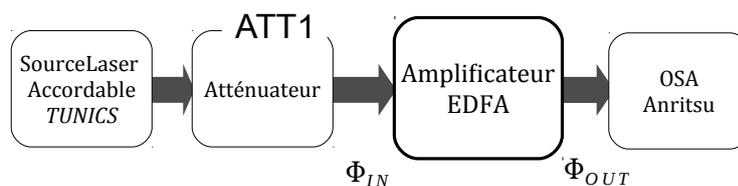
↪ Mesurer le spectre à la sortie de l'OSA entre 1500 et 1600 nm environ.
