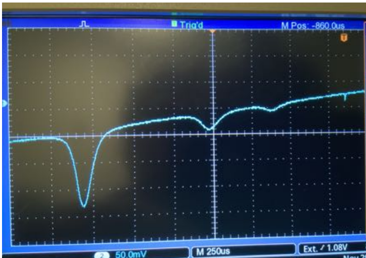
FIGURE 5.4 – Spectre d'absorption à travers le jet d'atomes. Ce spectre a été obtenu en utilisant le même montage que celui dont vous disposez, en mesurant l'intensité laser transmise à travers la chambre à vide et le jet atomique, en utilisant une photodiode amplifiée et en balayant la fréquence de la diode laser.
