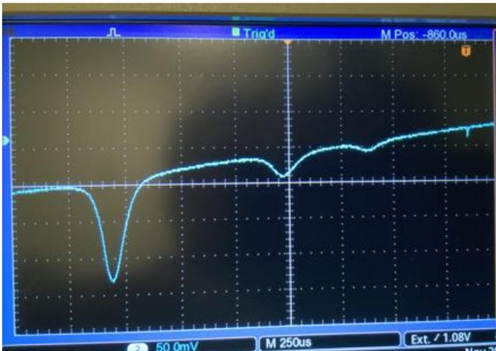
**FIGURE 5.4 – Spectre d'absorption à travers le jet d'atomes.**
