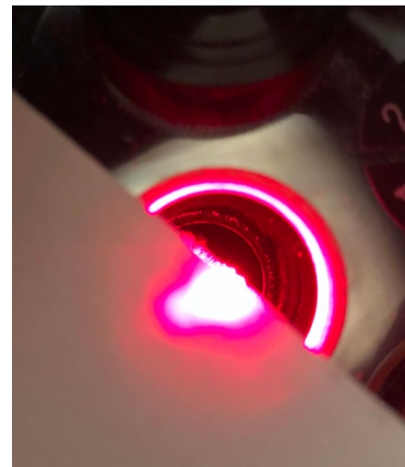
Spot laser centré sur le filetage de la tourelle porte-objectifs
