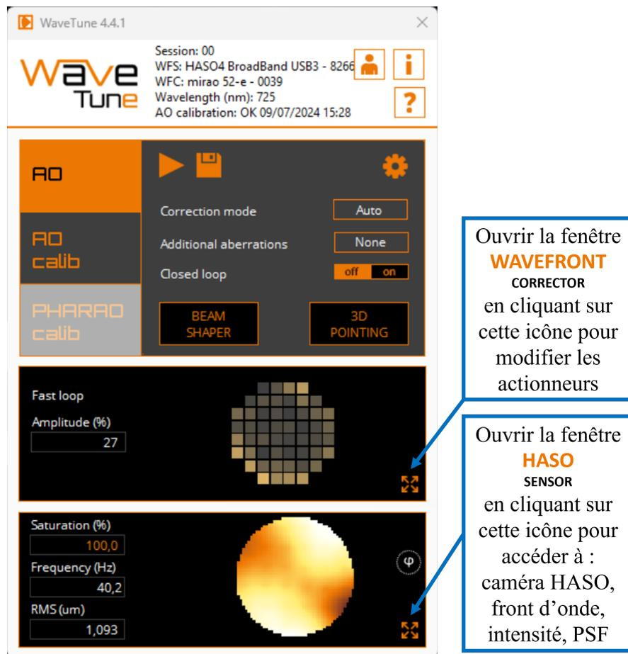
FIGURE 1.3 – Fenêtre principale du logiciel
