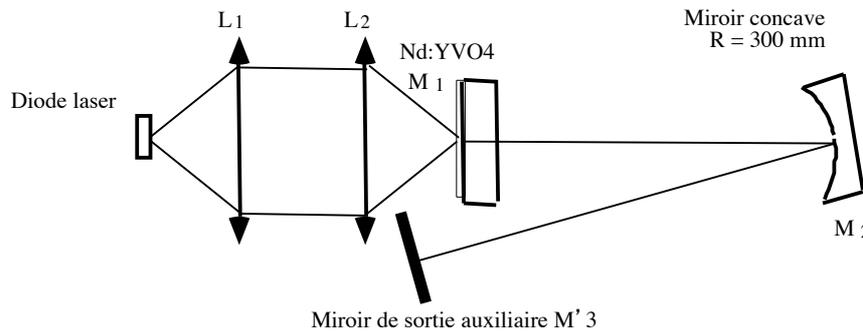
Fig. 4: Schéma de la cavité à trois miroirs.
