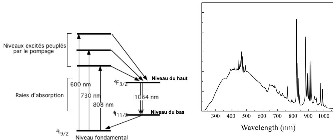
Fig.1 Gauche : Niveaux d'énergie du  $Nd^{3+}$ .
