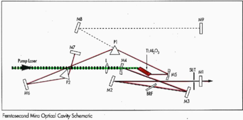
Figure 3 : Schéma de la cavité du laser femtoseconde.
