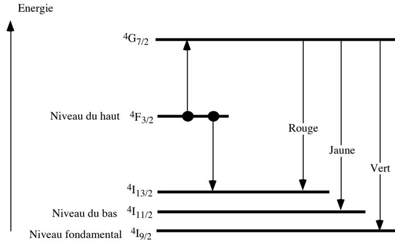
Fig.3 : Diagramme d'énergie partiel de l'ion  $Nd^{3+}$ .
