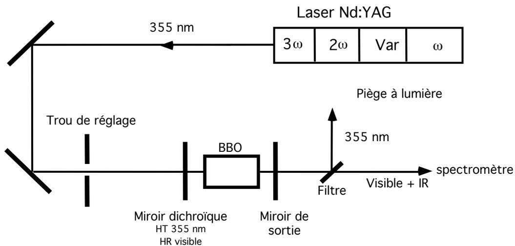
Fig. 1 : Schéma de principe de l'OPO visible
