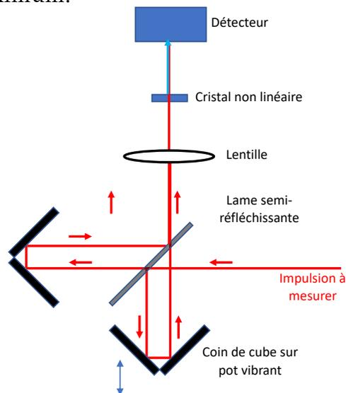
Figure 6 : autocorrélateur réglé en faisceaux colinéaires.
