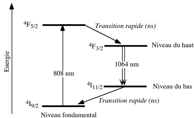
Fig.2 : Niveaux d'énergie du Nd<sup>3+</sup>.
