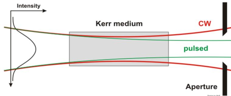
Figure 1 : Sélection du régime impulsionnel par effet Kerr
