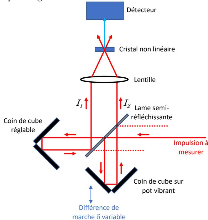
Figure 4 : Schéma de principe d'un autocorrélateur.
