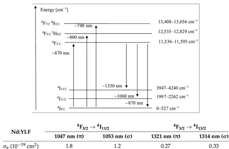
Fig.1 : haut : niveaux d'énergie simplifiés de l'ion néodyme 3+ dans la matrice de YLF d'après [3].
