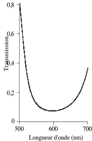
Fig. 2 : Transmission du miroir de sortie de l'OPO visible en fonction de la longueur d'onde.
