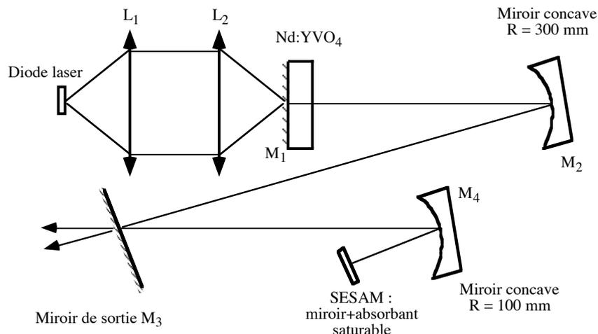
Fig.1 : schéma de la cavité.
