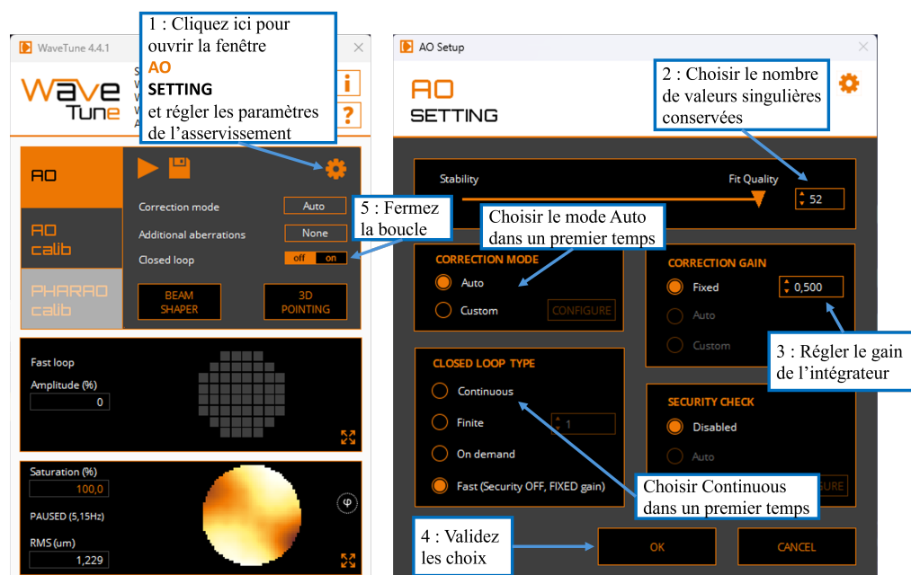
FIGURE 1.14 – Fenêtre « AO SETTING » permettant de régler les paramètres de l'asservissement et fermeture de la boucle dans l'onglet « AO »
