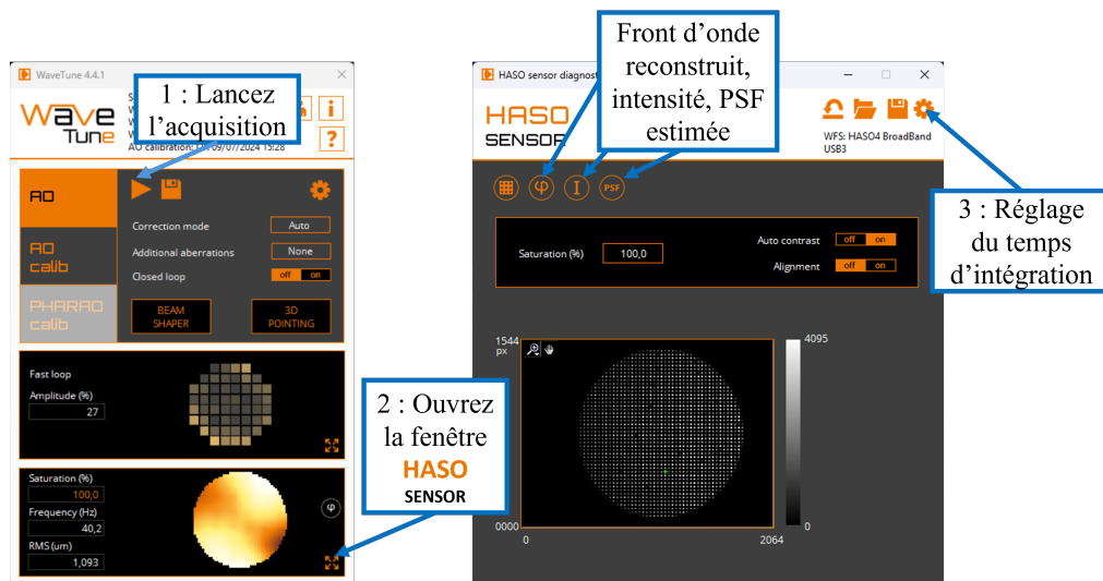
FIGURE 1.6 – Opérations conduisant à la fenêtre HASO SENSOR : signal de la caméra et accès aux autres menus du HASO
