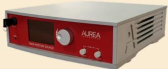
Par un processus d'optique **non linéaire (conversion paramétrique de type II)**, le cristal génère une paire de photons de **polarisations orthogonales** à  $\lambda=1550,3$  nm
