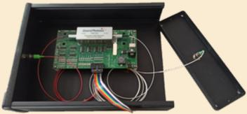
composant actif permettant de **choisir l'état de polarisation** de sortie d'un photon incident polarisé verticalement
